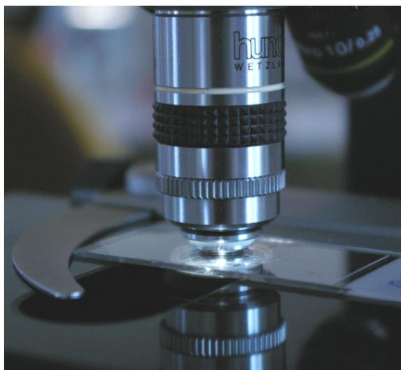
**Abb. 4:** Objektiv Plan 100/1,25 – 0,60 Oel mit Irisblende.
