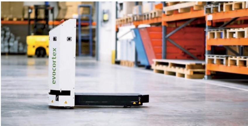
Indem man Drehrichtung und Drehgeschwindigkeit der einzelnen Räder variiert, kann man das Fahrzeug aus dem Stand in jede beliebige Richtung steuern oder auf der Stelle drehen lassen. Auf der horizontalen Ebene kann es sich so frei bewegen wie ein Schwebefahrzeug. Somit ermöglichen die Mecanum-Räder eine wendige und omnidirektionale Bewegung des Roboters.
